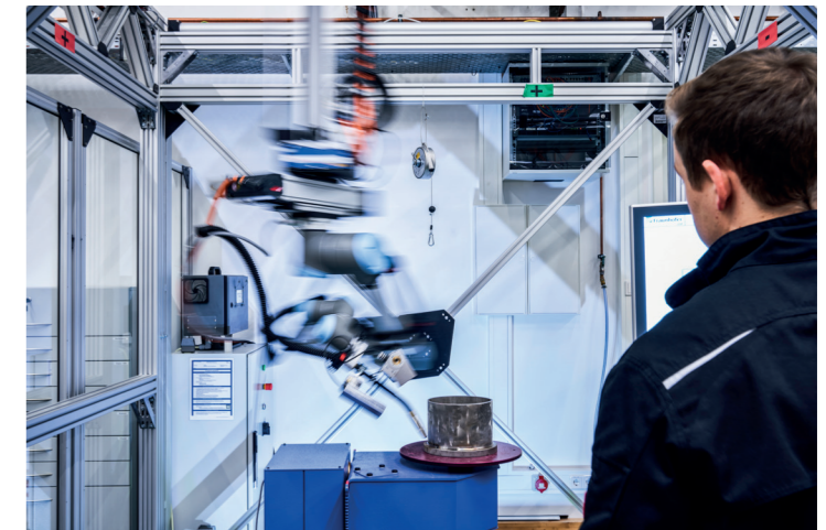
Schweißprozesse lassen sich mit kollaborativen Robotern (Cobots) auch bei Losgröße 1 wirtschaftlich automatisieren.
